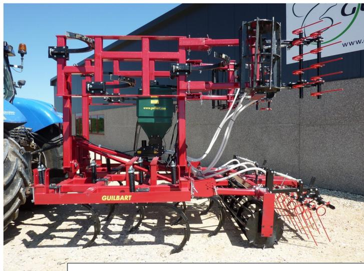
Bilame 4,5M repliable avec semoir; rouleau fer plat et double herse peigné
